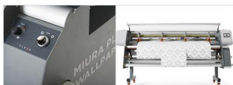
Miura II Plus WP per carta da parati: assi anteriori di riavvolgimento motorizzati, velocità regolabile, frizioni indipendenti
