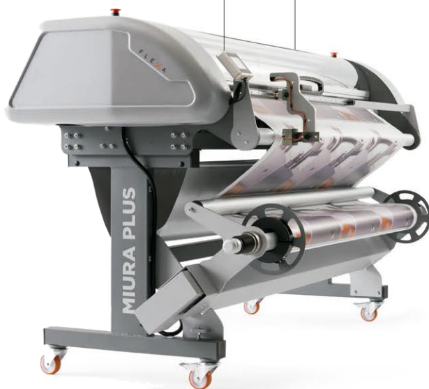
Miura II Plus WP per carta da parati: assi anteriori di riavvolgimento motorizzati, velocità regolabile, frizioni indipendenti
